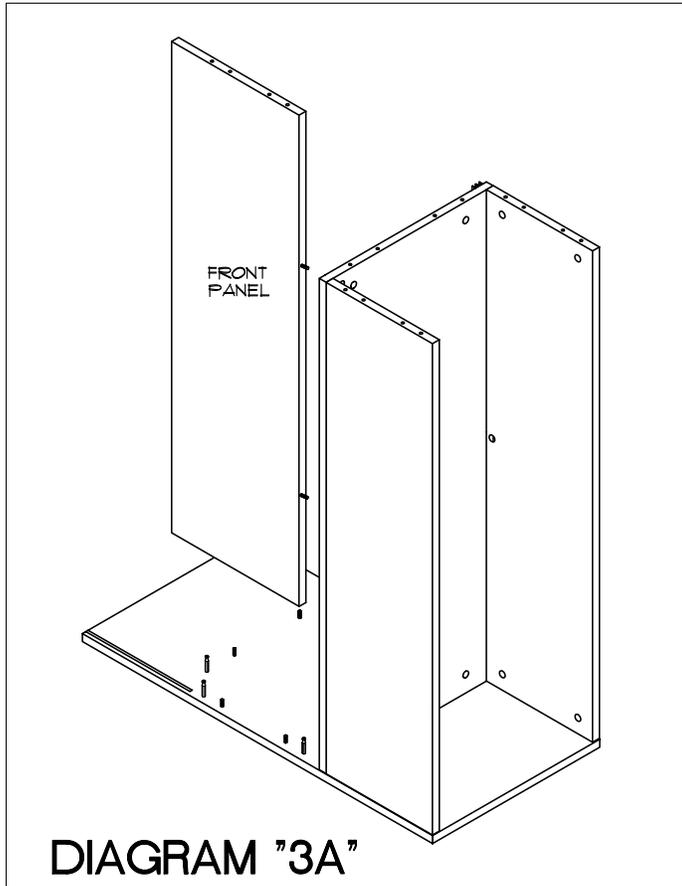
MAKE SURE THAT CAM LOCK PINS AND WOOD DOWELS ARE IN-LINE BEFORE PUSHING DECK PANEL ON END PANEL.
