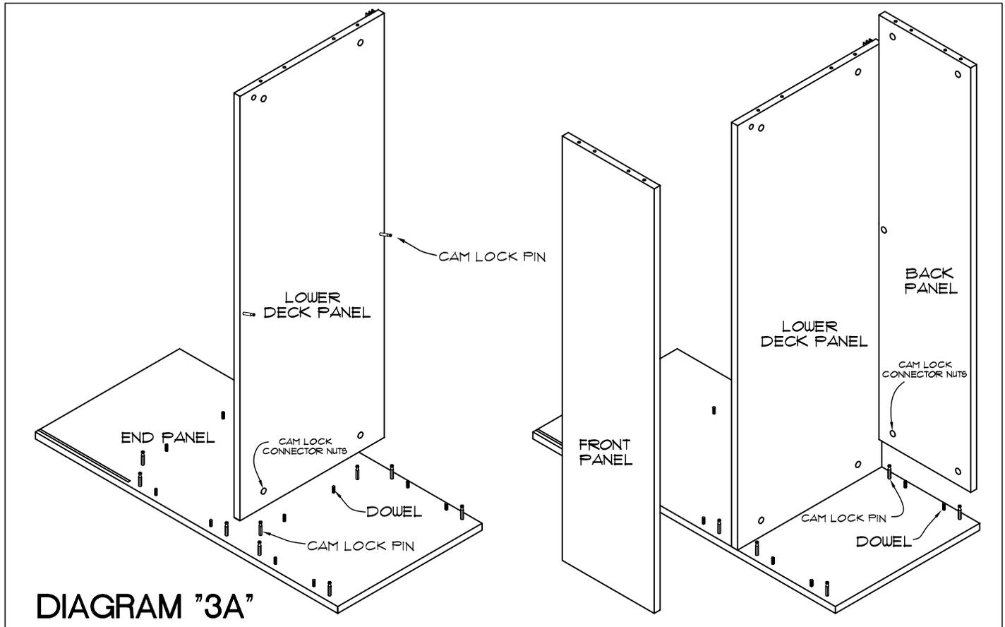
MAKE SURE THAT CAM LOCK PINS AND WOOD DOWELS ARE IN-LINE BEFORE PUSHING DECK PANEL ON END PANEL.
