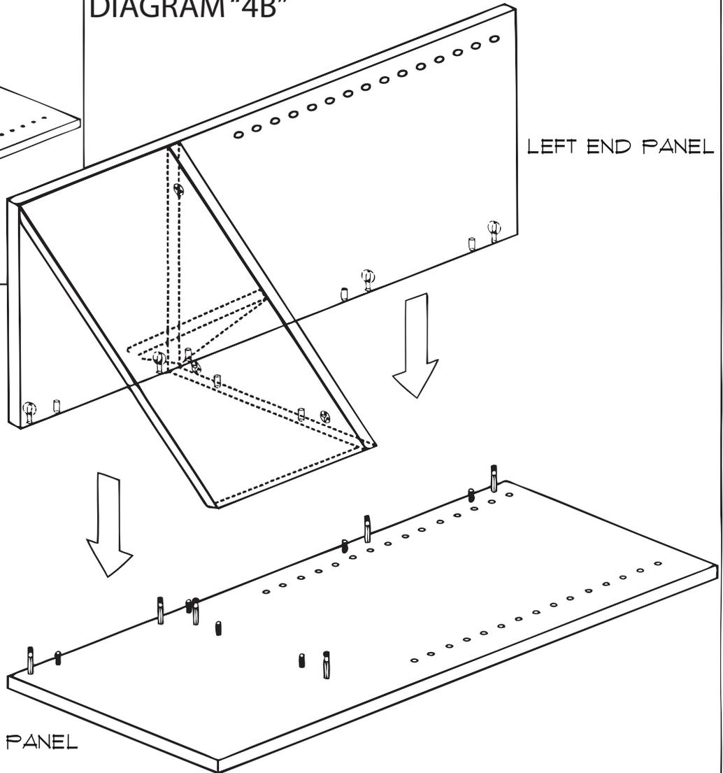
MAKE SURE THAT CAM LOCK PINS AND WOOD DOWELS ARE IN-LINE BEFORE PUSHING DECK PANEL ON END PANEL.
