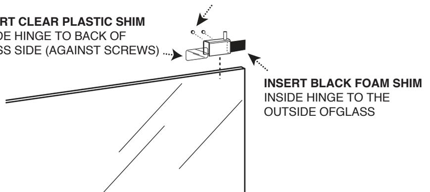
INSERT **BLACK FOAM SHIM** INSIDE HINGE TO THE OUTSIDE OF GLASS
