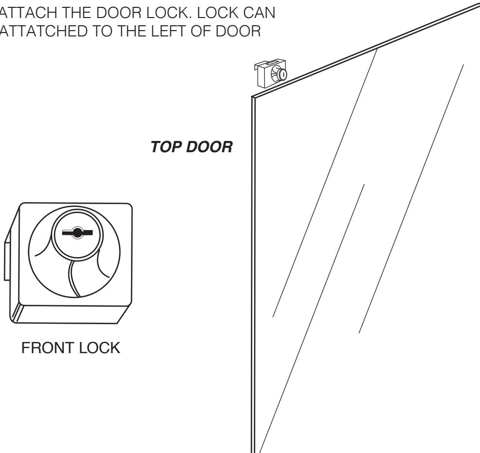
ADJUST DOOR BEFORE ATTACHING THE LOCK.
