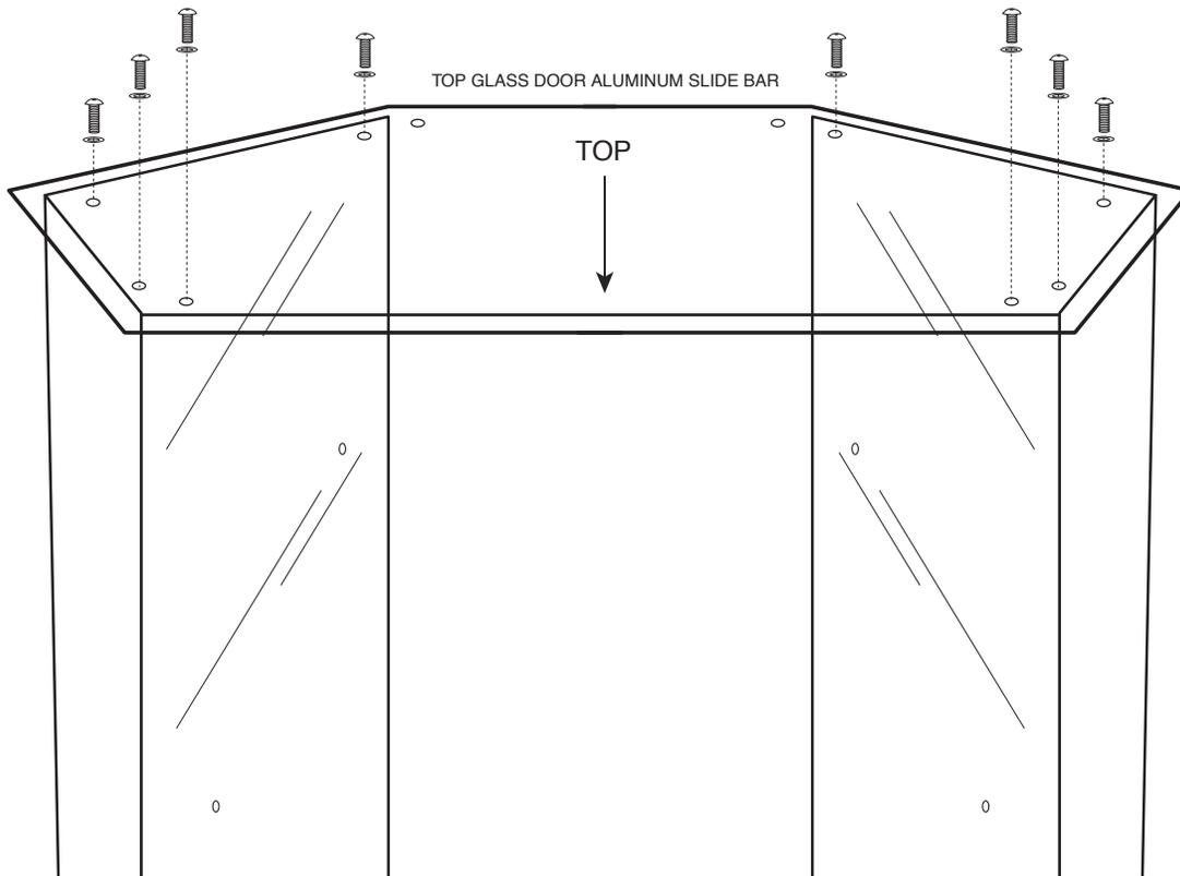
**STEP 11.** PLACE TOP GLASS DOOR ALUMINUM SLIDE GUIDE UNDER TOP GLASS.
