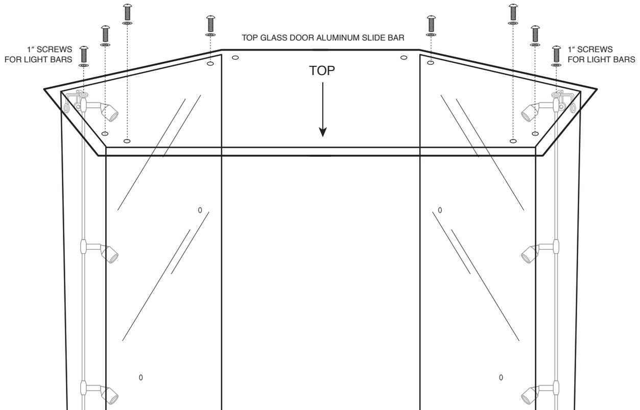
**STEP 11.** PLACE TOP GLASS DOOR ALUMINUM SLIDE GUIDE UNDER TOP GLASS.
