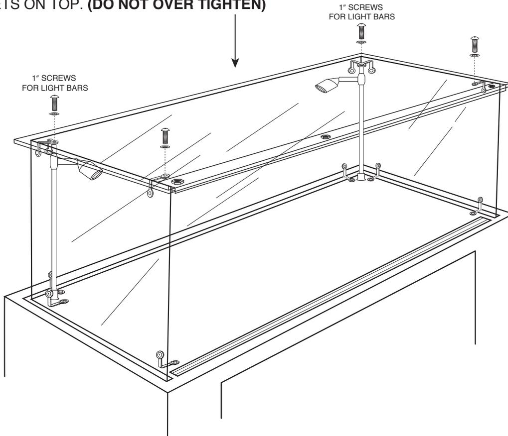
**STEP 13.** PLACE TOP GLASS DOOR ALUMINUM SLIDE GUIDE UNDER TOP GLASS.
