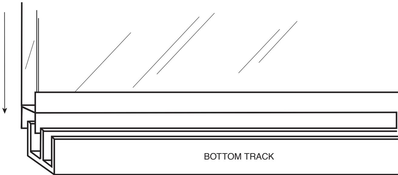
**STEP 16.** INSERT LEFT DOOR (WITHOUT LOCK - MAKE SURE HOLE IN BOTTOM METAL SLEEVE IS FACING YOU / ON THE RIGHT) INTO TOP OF BACK TRACK, THEN LOWER INTO BOTTOM BACK TRACK AND SLIDE TO THE LEFT.
