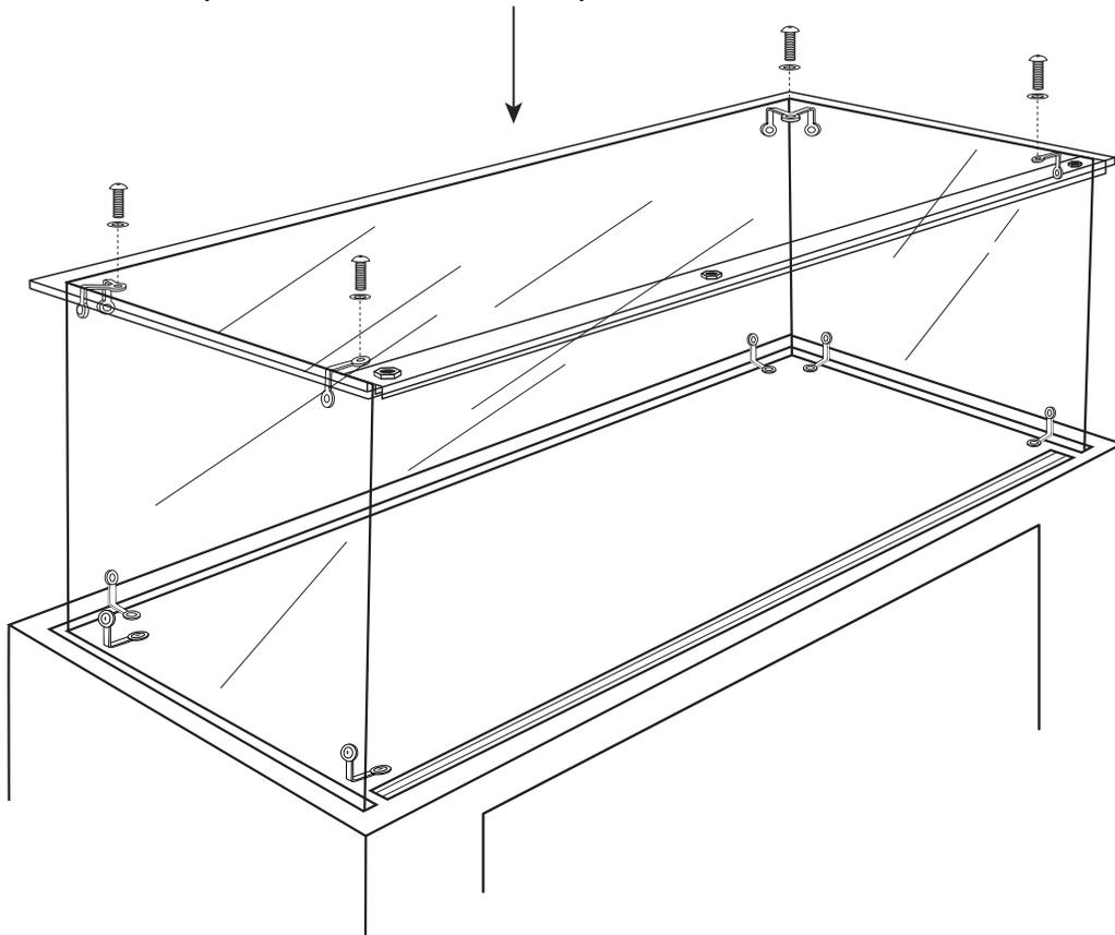
**STEP 13.** PLACE TOP GLASS DOOR ALUMINUM SLIDE GUIDE UNDER TOP GLASS.
