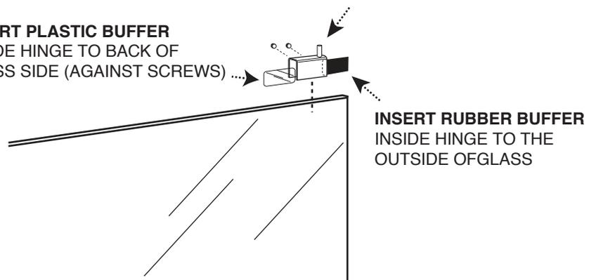
**INSERT RUBBER BUFFER** INSIDE HINGE TO THE OUTSIDE OF GLASS
