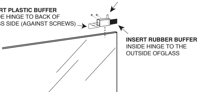
**INSERT RUBBER BUFFER** INSIDE HINGE TO THE OUTSIDE OF GLASS
